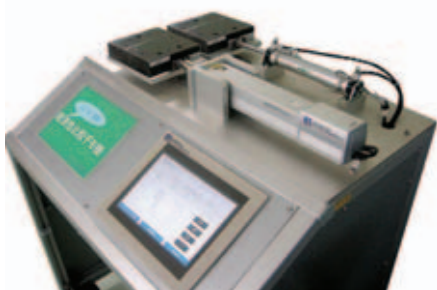
IAI wendete ein genaues Energieermittlungsverfahren zum Messen der Energieeffizienz an. Sowohl ein Pneumatikzylinder als auch ein RoboCylinder wurden unter identischen Bedingungen mit den folgenden Parametern getestet: Druckhaltezeit, Energiekosten pro Einheit, Druckluftkosten pro Einheit, Geschwindigkeit, Zuladung, Hublänge, Umgebungstemperatur und Betriebsdauer.
